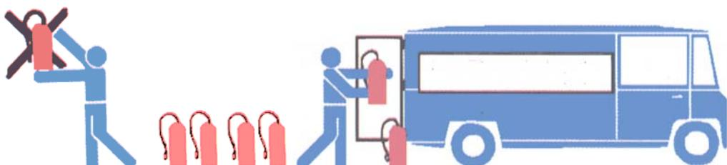
Φρόντισε αμέσως για την αναγόμωση των πυροσβεστήρων που χρησιμοποιήθηκαν, καθώς και για την ετήσια συντήρησή τους.
