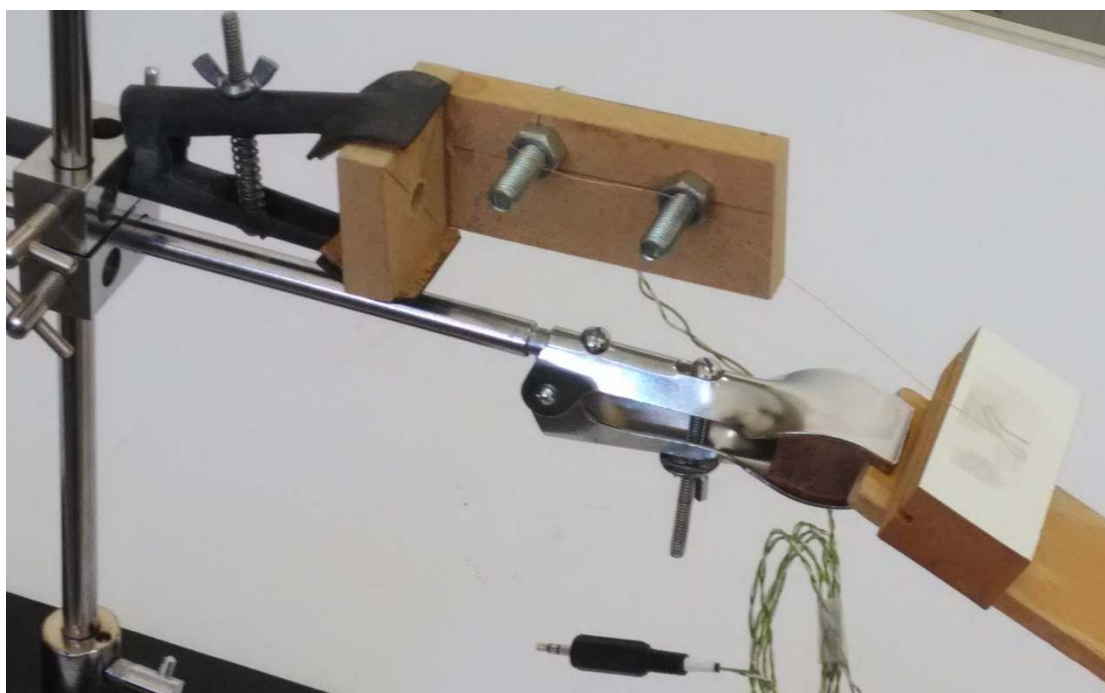
Εικόνα 57: Λεπτομέρεια από τον διακόπτη τύπου "διπλής βίδας"
