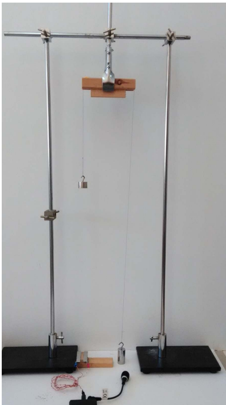
Εικόνα 33: Η πειραματική διάταξη της μηχανής Atwood
