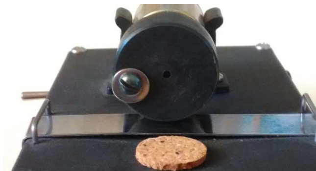
Εικόνα 49: Λεπτομέρεια του χρονομετρητή ταινίας
