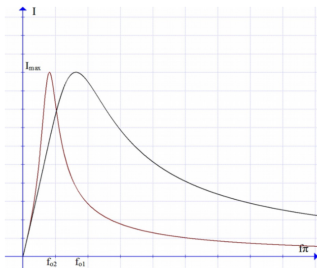
Σχήμα 1: Καμπύλες συντονισμού για δύο διαφορετικές τιμές του συντελεστή αυτεπαγωγής ( L_2 > L_1 )
