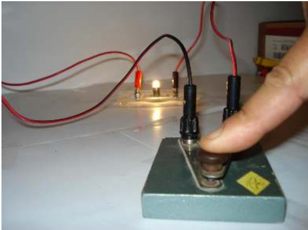
Διακόπτης μπουτόν εργαστηρίου. Κλειστός
