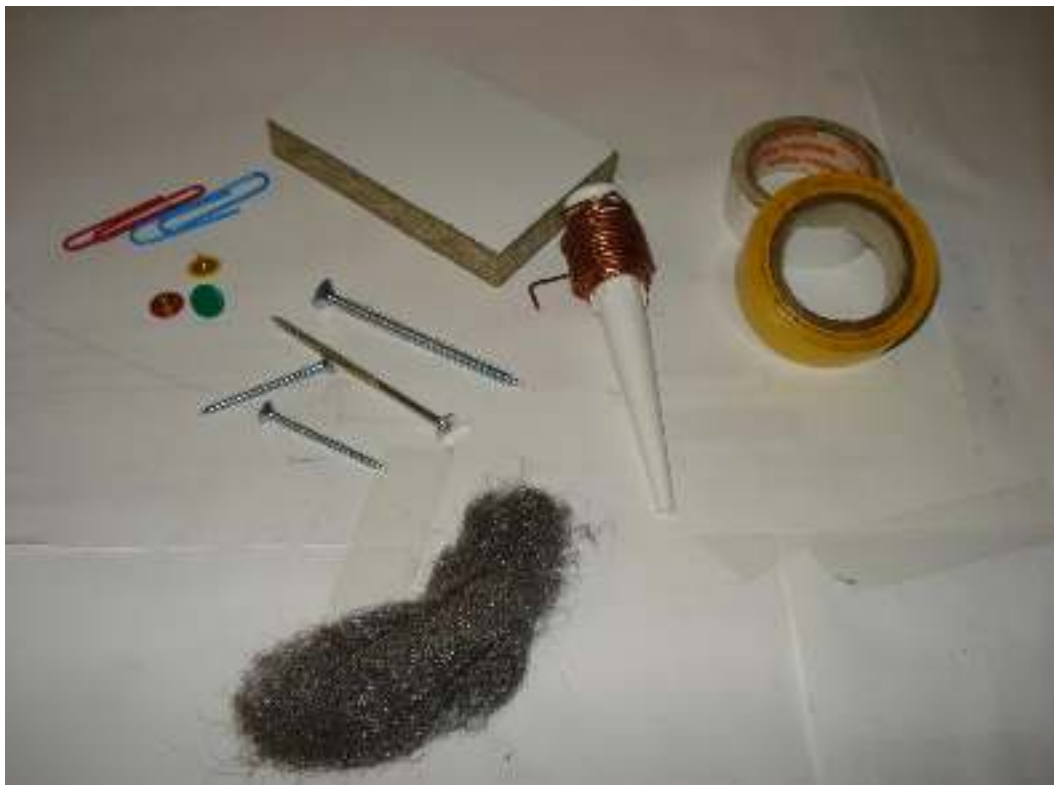
Πινέζες – Συνδετήρες – Μονωτική ταινία Ξύλο διαστάσεων 10X15X2 εκ. – Βίδες Σύρμα χαλκού – Συρματάκι κουζίνας
