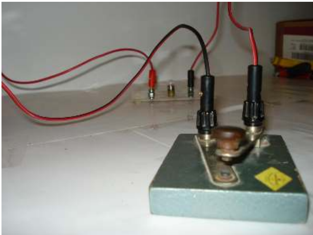
Διακόπτης μπουτόν εργαστηρίου. Ανοικτός
