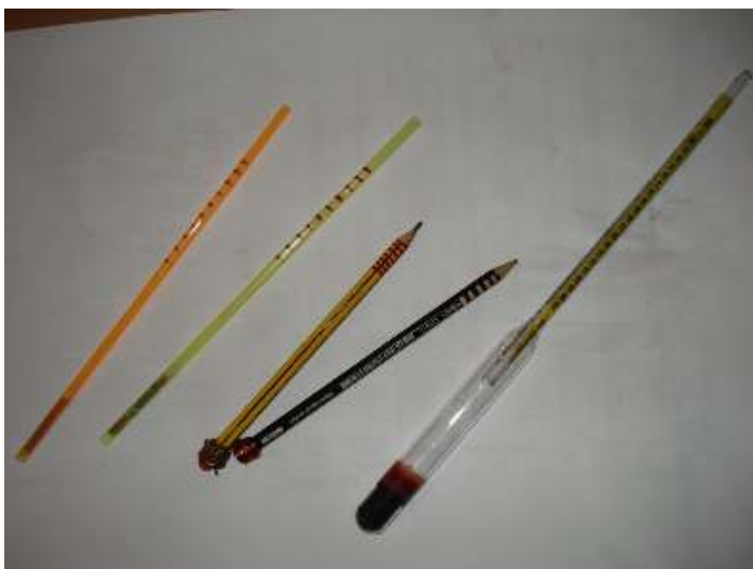
Πυκνόμετρο με μολύβι – Πυκνόμετρο με πλαστικό καλαμάκι Πυκνόμετρο εμπορίου
