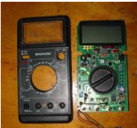
Εικόνα 9: Το εσωτερικό και το εξωτερικό του ψηφιακού πολύμετρου
