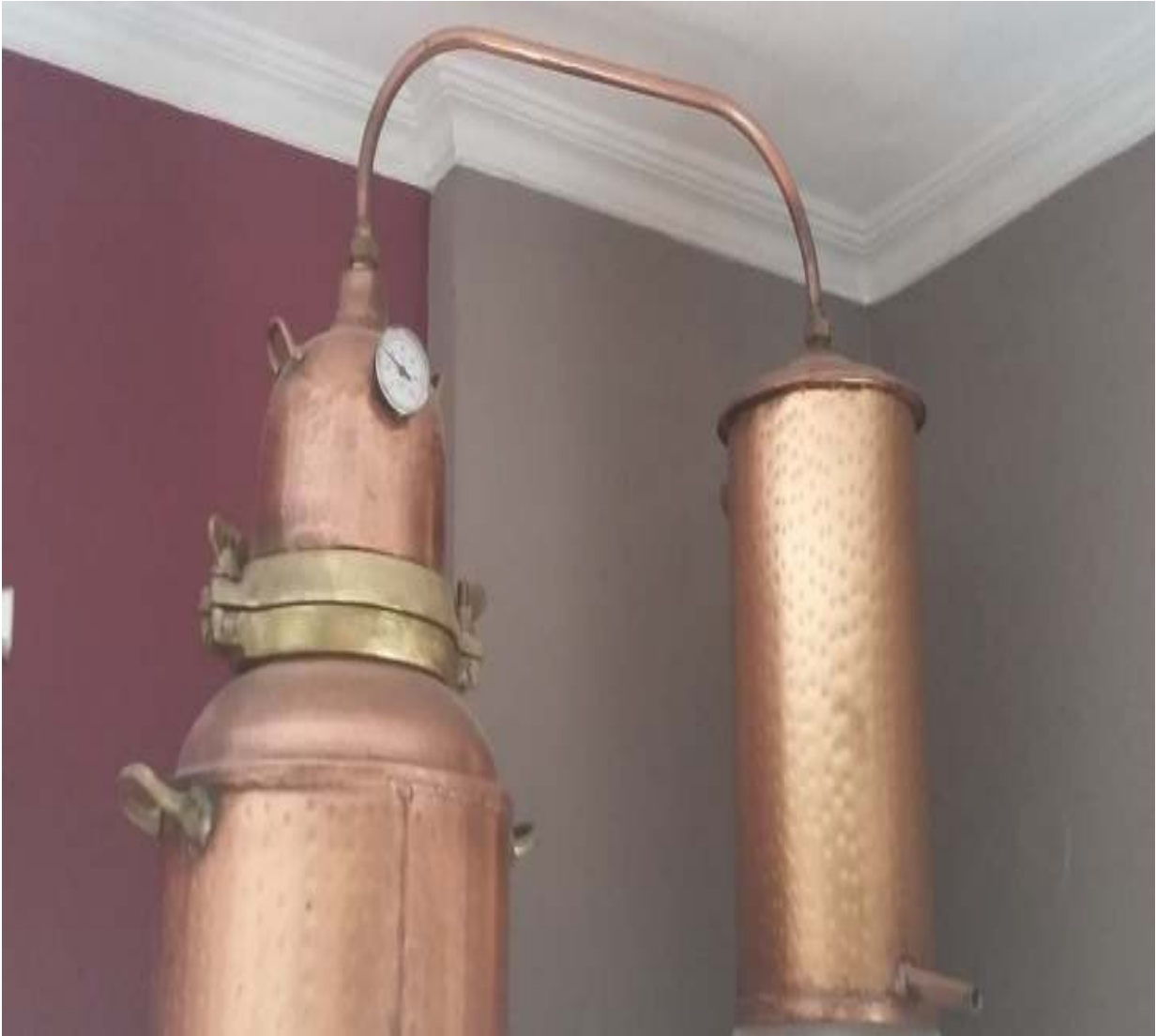
Χάλκινη πειραματική συσκευή απόσταξη για τσίπουρο
