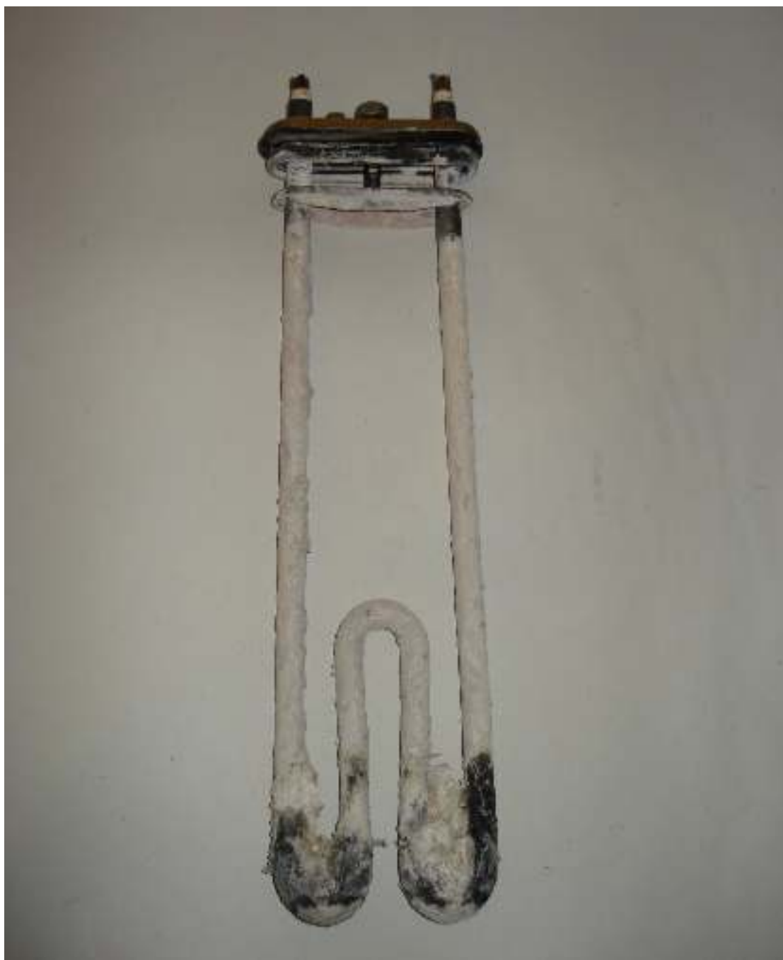
Αντίσταση πλυντηρίου καταστραμμένη από άλατα
