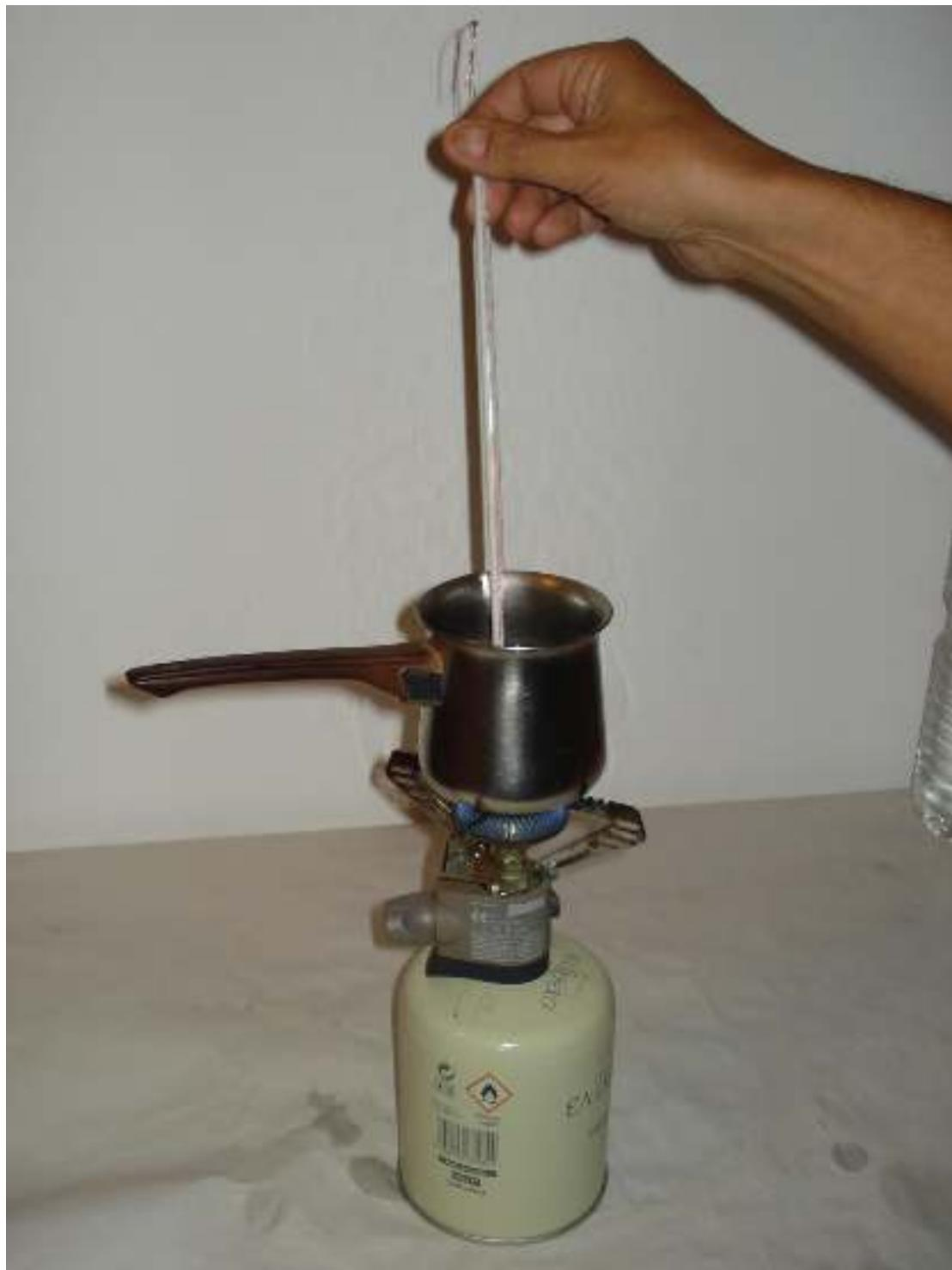
Βάλε κρύο νερό στη λεκάνη, σε ύψος 3-4cm και μέτρησε τη θερμοκρασία του.
