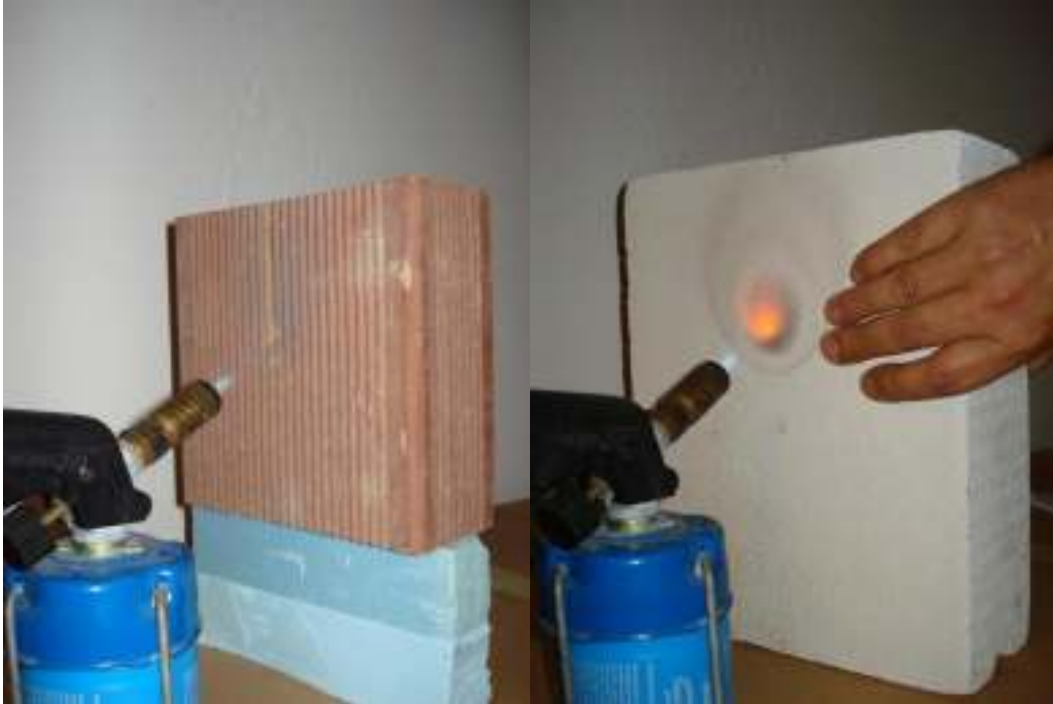
Τούβλο απλό από πηλό Τούβλο θερμομονωτικό Φλόγιστρο
