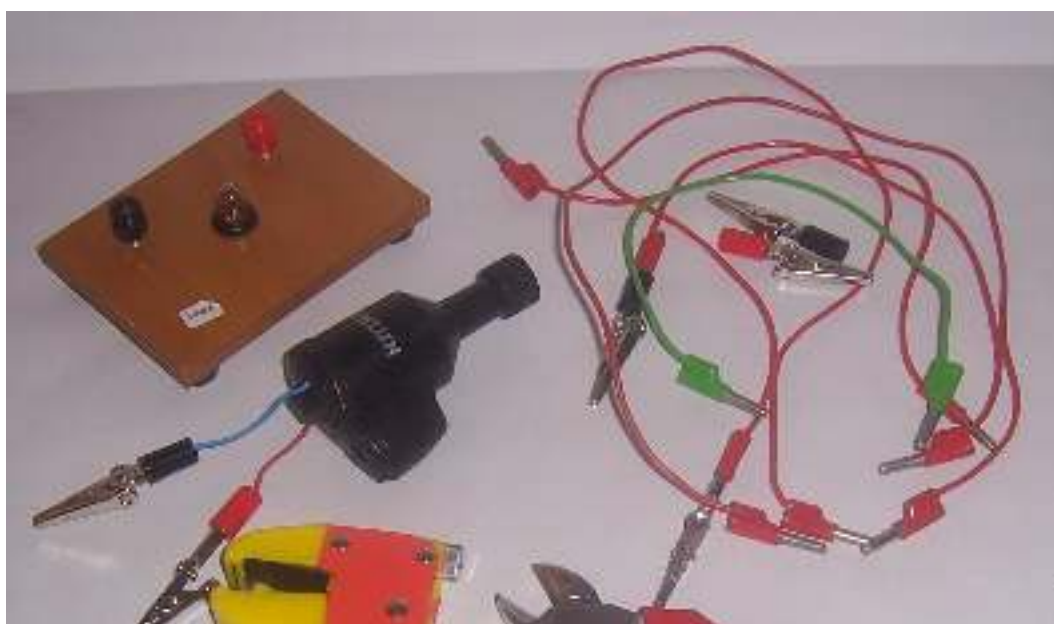
Δυναμό ποδηλάτου Καλώδια με μπανάνες και κροκοδειλάκια Λυχνιολαβή με λαμπάκι
