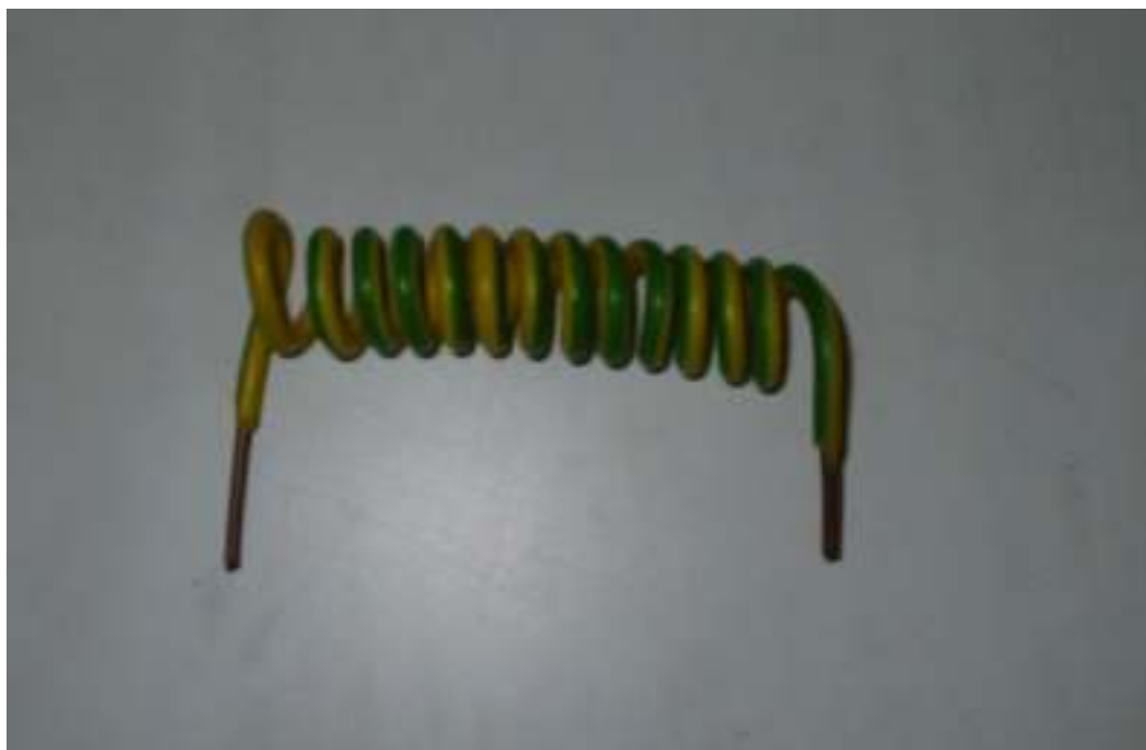
Πηνίο με καλώδιο μεγάλου διαμετρήματος
