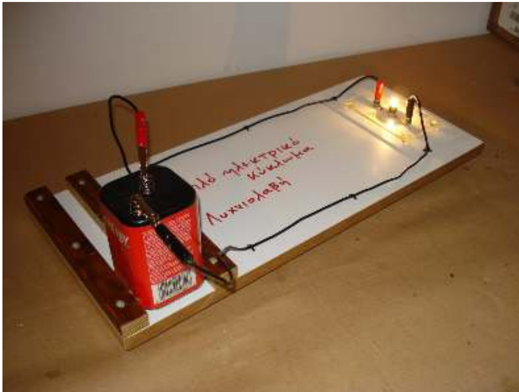
Απλό ηλεκτρικό κύκλωμα με λυχνιολαβή. Κλειστό
