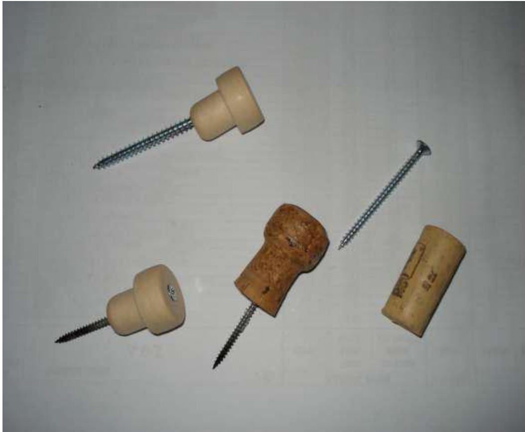
Βίδα με θερμομονωτική λαβή για τρύπημα πλαστικών μπουκαλιών
