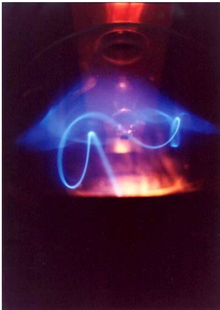
Σχήμα 8. Φωτογραφία της ελικοειδούς τροχιάς ηλεκτρονίων σε μαγνητική φιάλη.
