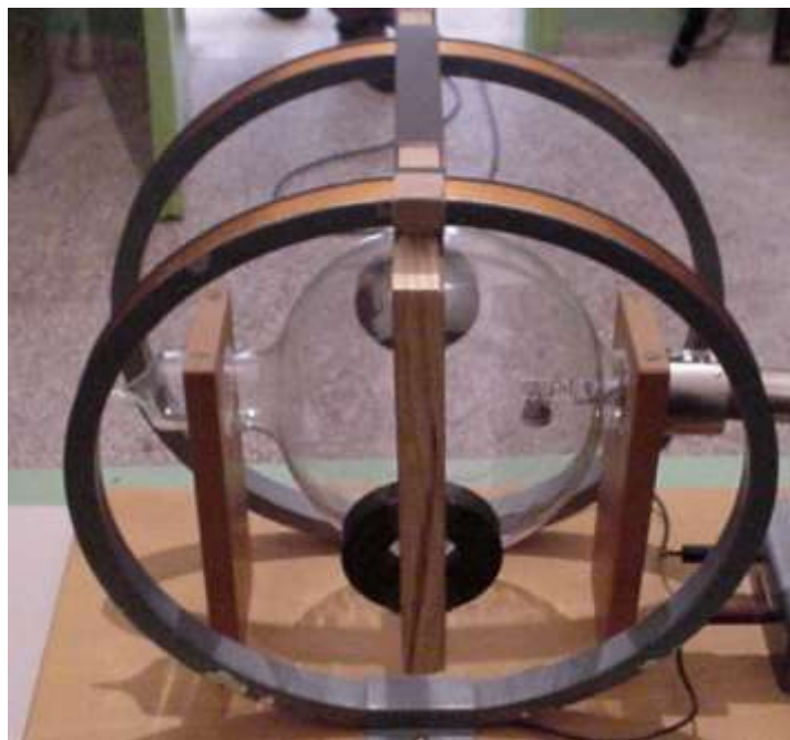
Σχήμα 1. Φωτογραφία του σωλήνα LEYBOLD. Διακρίνονται τα πηνία Helmholtz και οι πρόσθετοι κυκλικοί μόνιμοι μαγνήτες στα κέντρα των πηνίων Helmholtz.
